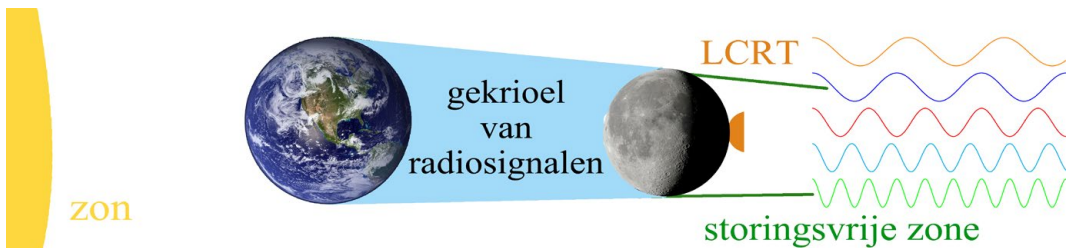
Figuur 2: de 'Lunar Crater Radio Telescope' (LCRT) zal gevoelig zijn voor radiogolven, die vanop de aarde geblokkeerd worden door de ionosfeer en zal ook afscherming bieden tegen de talloze elektromagnetische golven die op aarde opgewekt worden. (Saptarshi Bandyopadhyay)
