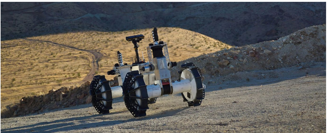
Figuur 4: de DuAxel-robotwagen is hier te zien tijdens terreintesten in de Mojave woestijn. De vierwielige robotwagen bestaat uit twee Axel-robots. Het ene deel verankert zichzelf op zijn positie, terwijl het andere een kabel gebruikt om anders ontoegankelijke contreien te verkennen. Bron: NASA / JPL-Caltech / J.D. Gammell.
