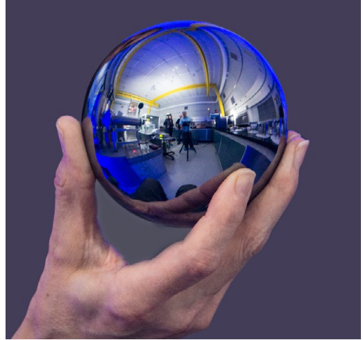
Siliciumbol vergelijkbaar met degene gebruikt in de Avogadrogetal-metingen (foto: BIPM).
