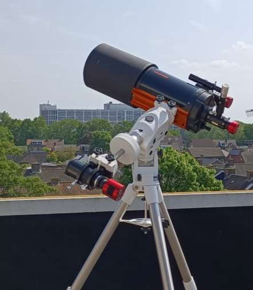
Celestron 8 en Foto Spiegel Obj. 500 mm f/8 Mount : AZ-EQ6 goto Skywatcher ..
